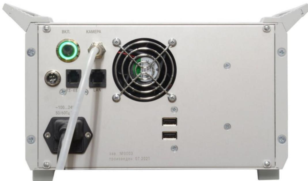
Рисунок 3 – Внешний вид задней панели Контроллера давления КДБ-1.
