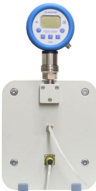
Рисунок 5 – Внешний вид барокамеры сзади с установленным эталонным преобразователем давления ПДЭ-020И.
