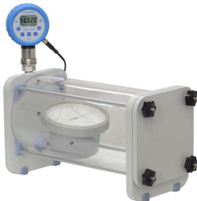
Рисунок 4 – Внешний вид барокамеры с установленным эталонным преобразователем давления.
